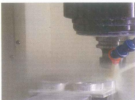
Как партнёр по разработке системных решений, прежде всего, мы делаем виртуальный дизайн отливки с использованием компьютера. После утверждения дизайна нашими инженерами, выполняется механическая обработка с очень высокой чувствительностью с использованием современной CNC машины с 5 осями для производства форм.
