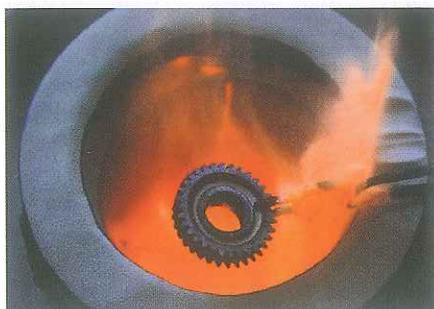
Термическая обработка применяется для устранения остаточного напряжения и достижения необходимой твердости и ударной прочности.
