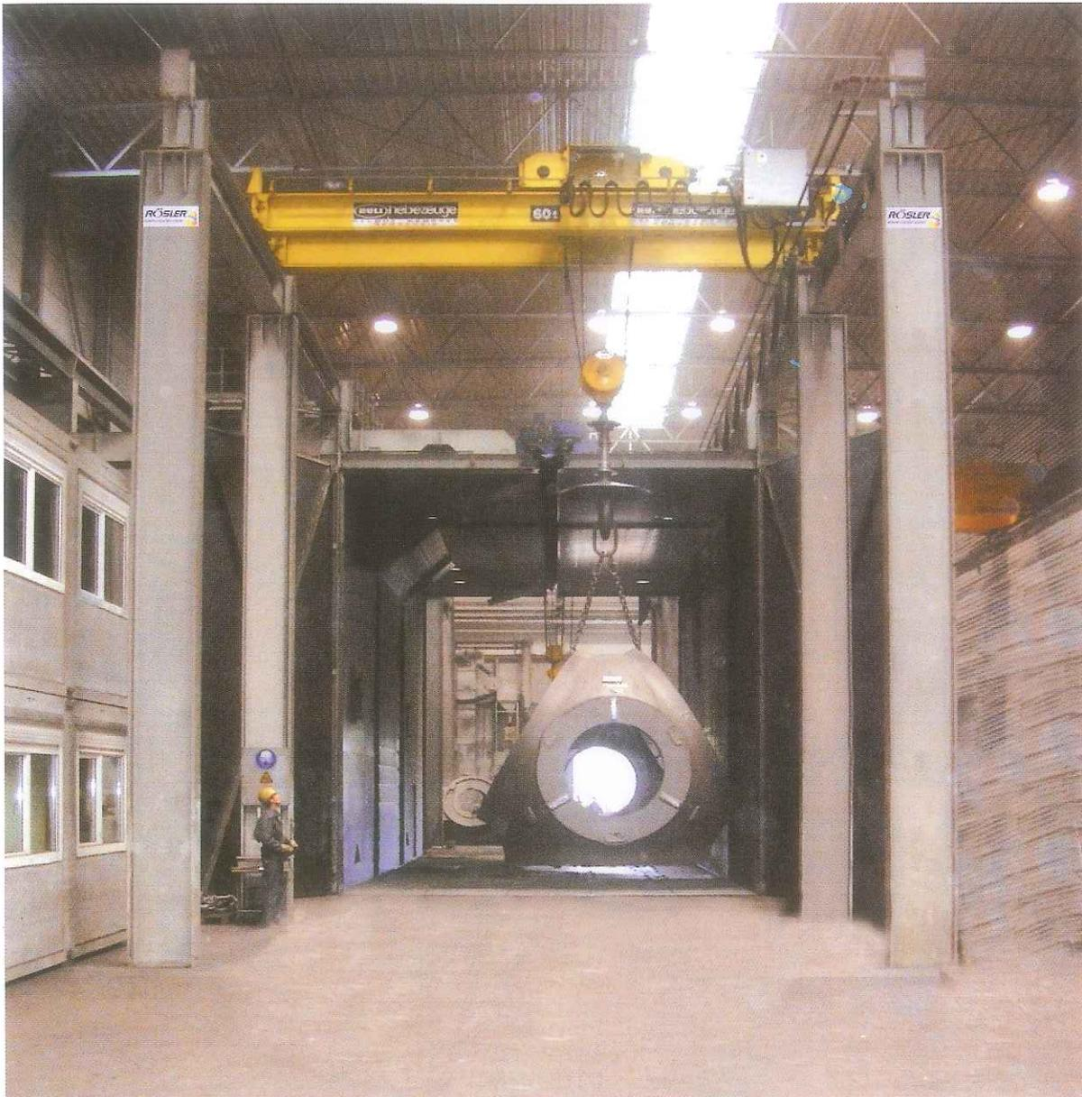
(Изображение 1) Дробеструйная машина камерного типа
